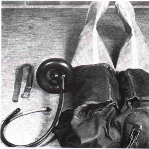
Provdonet med sina två luftslangar och ett band, som håller det på plats, när strumpan sätts under tryck.
