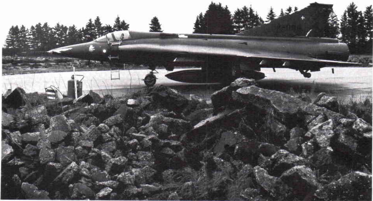
Danskarnas 35XD får stå utomhus året runt. Stenblocken i förgrunden är avsedda att binda dammet när motorn startas.
