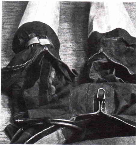
Provdonet med sina två luftslangar och ett band, som håller det på plats, när strumpan sätts under tryck.
